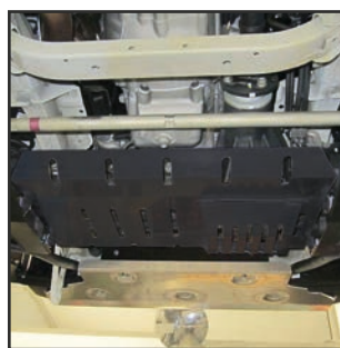
PONTE ANTERIORE 1.5 AT, MT 4wd Acciaio 2mm
