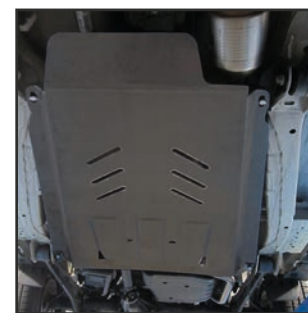
PROTEZIONE TRASMISSIONE / CAMBIO 1.5MT 4wd Acciaio 2mm
