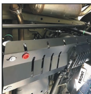
PONTE POSTERIORE 1.5 AT, MT 4wd Acciaio 2mm
